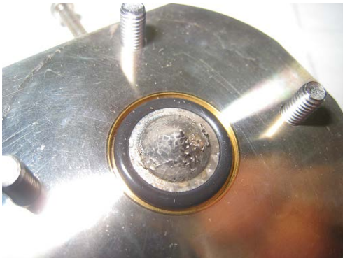
図8 照射後のNi表面 (p 12 MeV, 0.1 \mu A, 15分) ビームによるNi層の損傷は見られなかった (Ni表面の様子は照射前後で変化していない)
