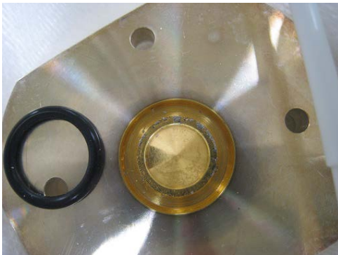
図9 溶解後のAu表面 (観察のためO-ringを外してある) 電着させたNiは全量溶解し、損傷のないAu/Ag表面を再度得ることが出来た
