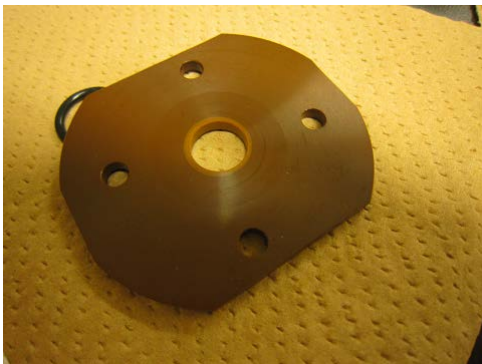
図10 照射・回収後のPEEK材 濃硝酸溶液との接触により一部変色したが、脆化は見られなかった。
