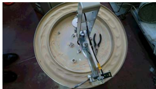
図-3 路面凹凸生成を模擬する室内実験装置
