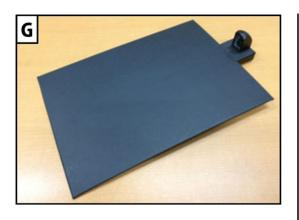
本試作機は,3-(3)- のピントに関する問題を解決するため,紙面とカメラ(及びミラー)の位置関係が常に一定になるように,撮影対象となる紙面を固定するための台座(図G写真中央の平面構造部)を有する.
