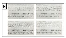
図Hは, 手前(カメラの近く)の文字にピントが合っている画像と, 奥(カメラから遠く)の文字にピントが合っている画像を含んでいるが, これらの画像を合成して疑似的に被写体深度が深い(全体にピントが合っている)画像を合成する(図I).
