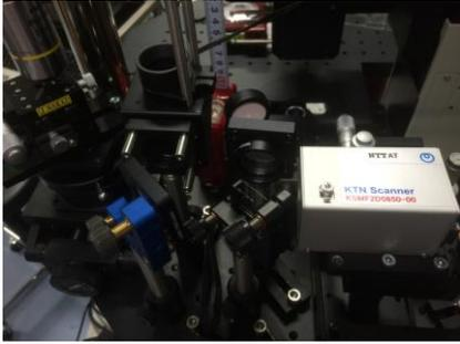
図3 開発した光刺激装置 (KTN スキャナー部) の写真
