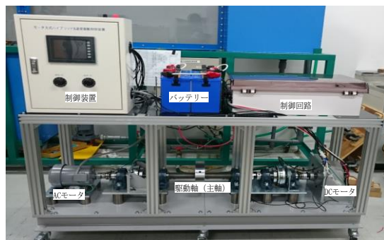
図 1 スターリングエンジン・モータ方式ハイブリッド駆動実験シミュレータ
