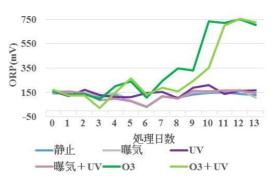
図 7 UV 照射とオゾン曝気による膜透過液の ORP の変化
