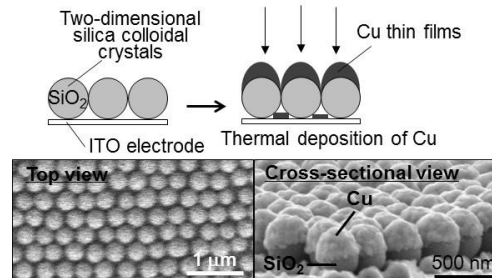
図 1. CuHS 構造の作製スキームおよび走査型電子顕微鏡像。
