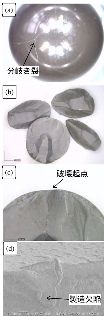
図3 熱衝撃破壊したセラミック球 (温度差 800K, 3/8inch, 雑誌論文 の転載)
