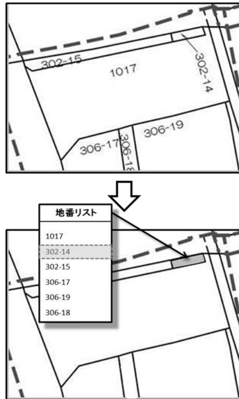
図2 地図情報の要素間の関連付けの例：地番参考図では、土地区画と地番が関連付けられる。
