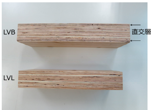
図 3 LVL の LVB の断面の様子
