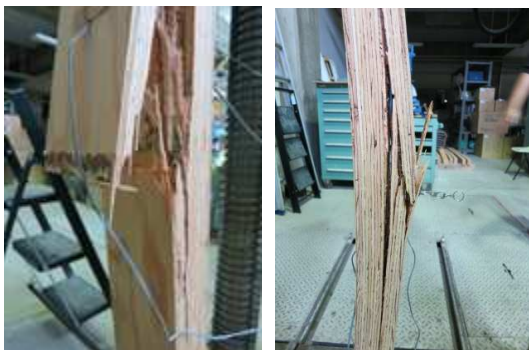
図7 曲げ破断の様子
