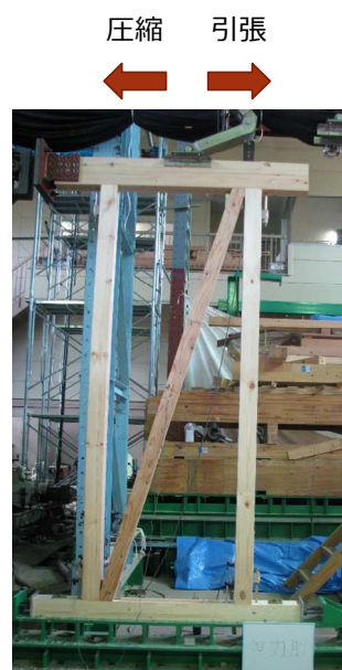
図 5 筋かい耐力壁の試験状況 (2)
