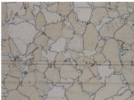
図2 自動エッチングを行なった鉄鋼断面
