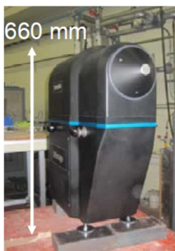
図6 導入した中性子カメラ
