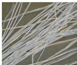
図14 マイクロ流路を用いて作製した非架橋性コラーゲンマイクロファイバー。
