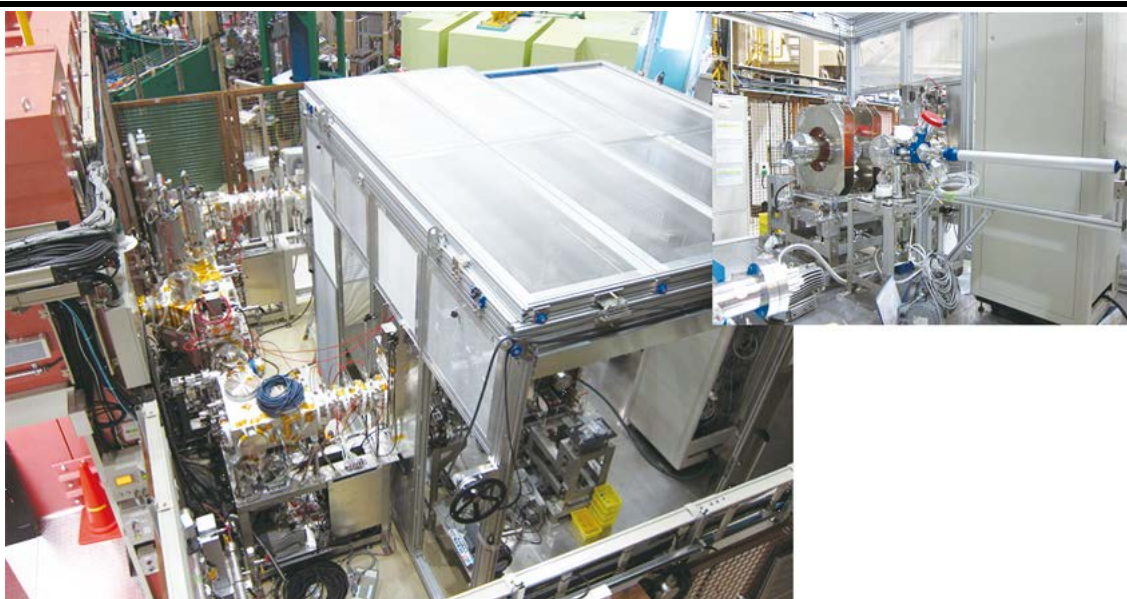
図 A01-5: U ラインの最近の様子。U1A エリアに設置された Kalliope 検出器から構成される nm- \mu SR スペクトロメータ。
