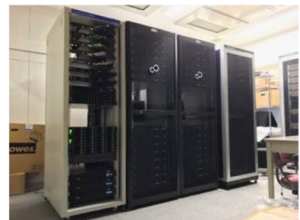
大阪市大に設置した低遅延のイベント探索用Linuxクラスタ計算機
