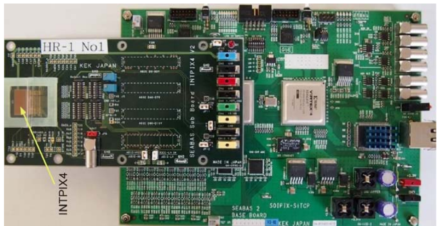
図 22. (左)ウエハーへの X 線自動照射装置。(右)SOI 検出器読み出しボード SEABAS2(SOI Evaluation Board with SiTCP)と INTPIX4 センサ・サブボード。
