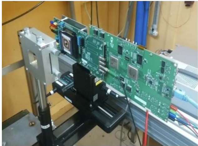
図 9. Double SOI で製作したテストチップの X 線ビームによる試験 (PF BL-14A)
