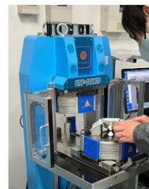
**中性子全散乱測定装置**：中性子全散乱測定技術に対して、水素化物の種類や反応条件に応じた少試料対応のオペランド化を充実化した（右写真：左側が単結晶サファイア製反応セル、右側がバナジウム製反応セル（スケールは150mmに相当））。これにより A05-1 を中心に領域内外の広域的な連携が進展して、例えば高密度水素化物 NaAlH<sub>4</sub> の触媒界面での詳細な反応素過程解析等が実現、この分野での30年来の未解明課題の解決に至った。さらに軽水素中性子非干渉性散乱成分の除去に有効な偏極中性子散乱測定に関する環境整備が進展した。
