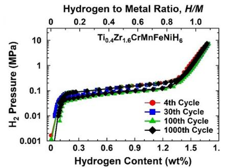
図 6.14.  $Ti_{0.4}Zr_{1.6}CrMnFeNi$  合金の水素吸蔵特性.
