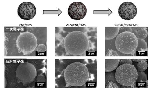
図 6.6. 新規開発プロセスによるハイエントロピー硫化物ナノ粒子の形成過程。
