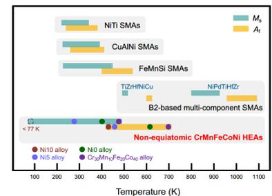
図 6.2. 各種形状記憶合金のマルテンサイト変態温度の比較。
