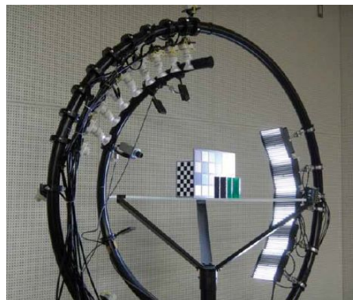
図4 さまざまな照明光を用いて物体の質感を詳細に計測するために開発された装置
