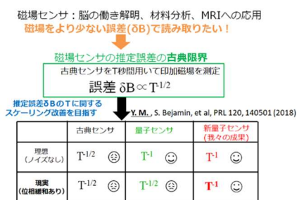
図2. ノイズがある環境下での磁場センサーの特徴的な振舞い
