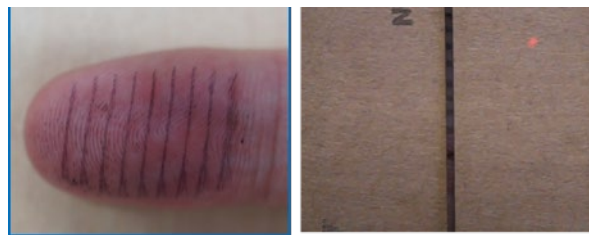
図 3：テクスチャなぞり時のスリット越し皮膚計測
