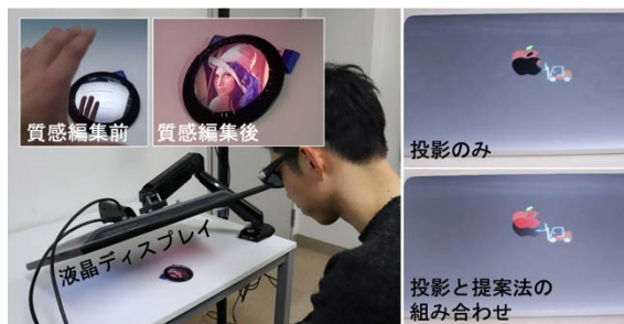
図6：映り込み変調による鏡面物体の質感編集
