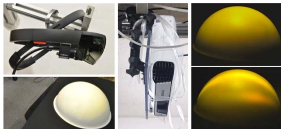
図4：プロジェクタと光学シースルー頭部搭載型ディスプレイの組み合わせによる質感表現 (右上：プロジェクタのみによる表示、右下：両ディスプレイ組み合わせによる光沢表示)
