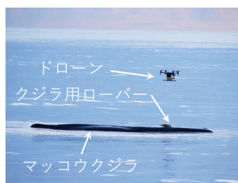
図2 ドローンを用いたクジラ用ローバー装着
