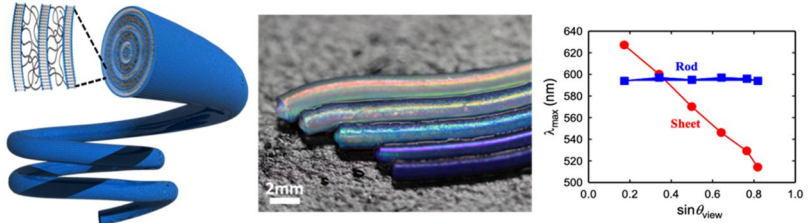
図 6 シリンダーフォトニックゲルの構造と角度非依存性構造色。
