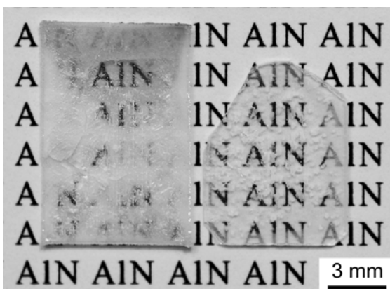
図 2 自発分離後の AlN 自立基板写真
