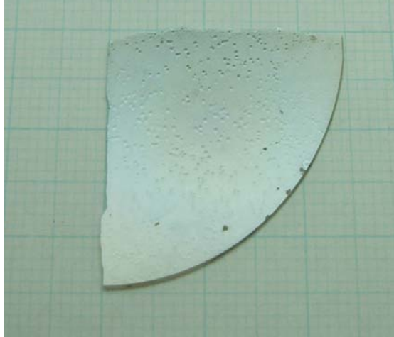
図5 AlGaIn 三元混晶の厚膜エピタキシャル層
