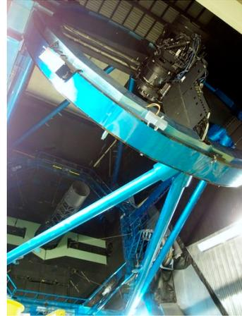
2012 年 8 月にエンジニアリングファーストライトに成功した際には国内外の報道にも多数取り上げられ、関心の高さが窺われた。その後も性能評価試験を続けた結果、従来の約 7 倍の視野 (満月 9 個分) において 0.5 秒角を切る世界最高レベルの優れた結像性能を発揮することが確認されている。
