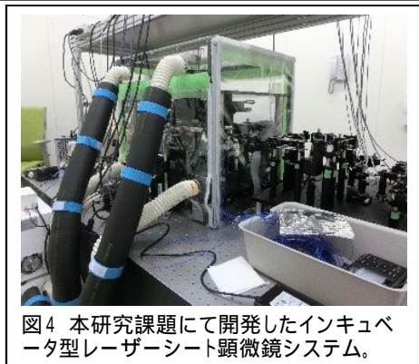
図4 本研究課題にて開発したインキュベータ型レーザーシート顕微鏡システム。
