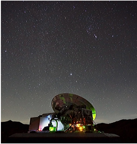
図1 左：大阪公立大学の1.85m電波望遠鏡。国立天文台野辺山宇宙電波観測所で運用されている。普段は、電波透過膜で作られたレドームで覆われている。右：本研究で開発した、広帯域受信システムの写真
