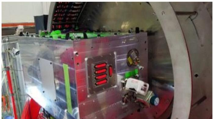
図 4 せいめい望遠鏡の焦点に取り付けられた新開発した近赤外偏光撮像装置
