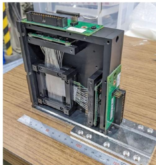
このために制動放射で得られる光子を標識化し、光子のエネルギーとタイミングを非破壊で測定することが重要である。上図(左)はこの目的のために新造した実光子標識化装置 (Tagger) である。また、光子ビームの分布をリアルタイムかつ  $10\mu\text{m}$  より良い精度で測定できるビームプロファイルモニター (上図右) の製作にも成功した。この測定器は当初期待していた以上の性能を発揮し、光子ビームのビームプロファイルのみならず加速器内の電子ビームの性質についても研究が可能であることが分かった(木野量子 (東北大学), 第 13 回測定器開発優秀修士論文賞, 2023 年)。
