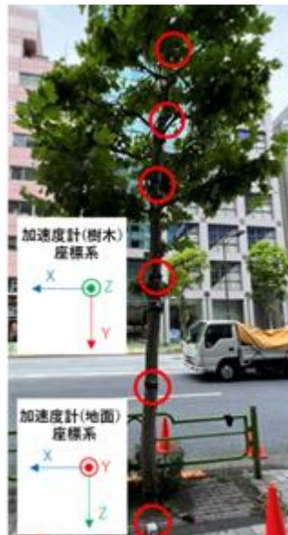
図10：ガードパイプの呑み込みを有する街路樹の常微動測定
