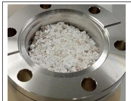
図4 本研究で製作した低バックグラウンド材料を用いたゼオライト。(H. Ogawa 他 JINST 19 (2024) P02004)
