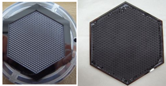
図 11. Si レンズアレイと反射防止膜
