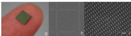
図10 試作テラヘルツ・光領域メタマテリアル. (g/h: テラヘルツ帯CRLH媒質, i: 赤外領域負透磁率(MNG)媒質)
