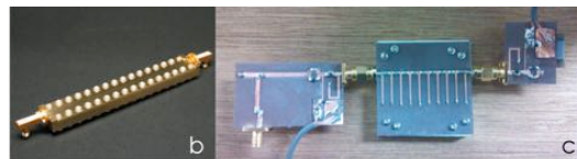
図8 その他のマイクロ波応用例 (W: ミリ波帯左手系導波管ビーム走査アンテナ, X: 電圧制御型偏波回転零次共振アンテナ)
