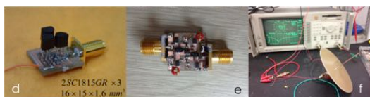
図9 ノンフォスター素子の開発例. (d: Linvill型NIC素子, e: エミッタフォロア型NIC素子, f: NIC素子を用いた小型アンテナの広帯域整合)
