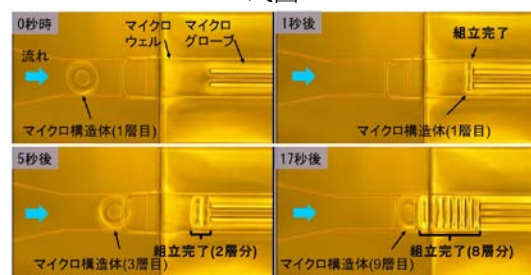
図6 マイクロチューブ(直径190 μm)の組立て結果
