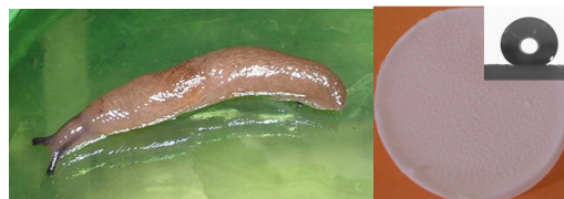
図3 左は粘性の分泌液により表面を清浄に保つナメクジ(犠牲的な表面清浄化)。右はナメクジの分泌機能を模倣したはつ液材料。
