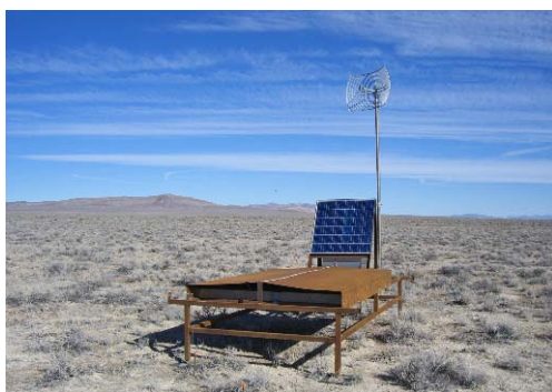
図 5 : 設置された地表検出器。発電のための太陽電池パネル、通信のための無線 LAN アンテナが見える。自然環境への配慮から、ヘリコプターによって設置点まで運搬され、設置された。
