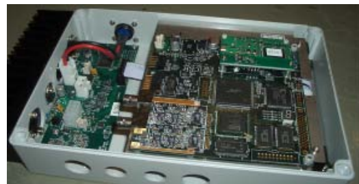
図3：地表検出器読み出し電子回路。50MHz 12bit ADCで波形を記録し、無線LANモデムで通信塔まで送り出す。時間記録はGPSのタイムスタンプで行う。
