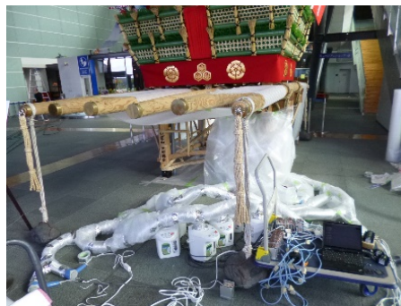
図2. 作成した加湿温風制御プログラムを使用した木部の処理例
