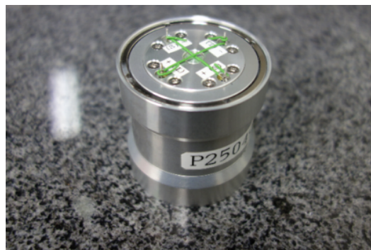
図 2: 短周期地震計(上下動)の外観。直径 50mm。固有周波数は約 3 Hz
