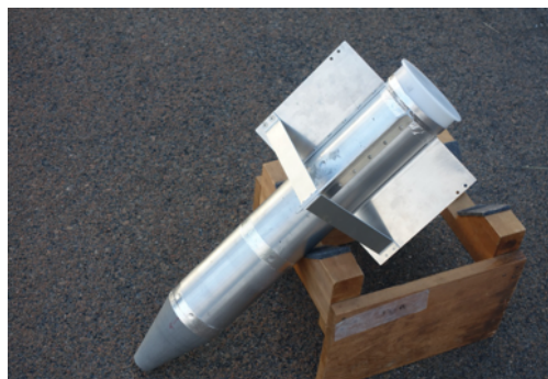
図4：投下貫入型ペネトレータ観測プローブ（直径10cm 全長60cm）
