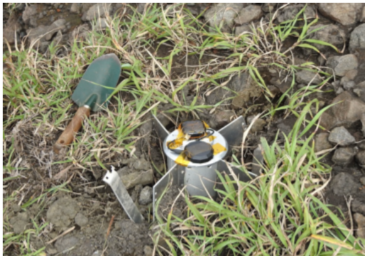
図6：諏訪之瀬島火口近傍に貫入させてペネトレータプローブ (テスト機)
