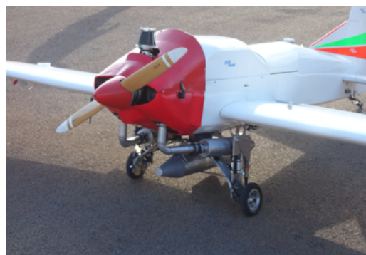
図5：ペネトレータを搭載した無人航空機
