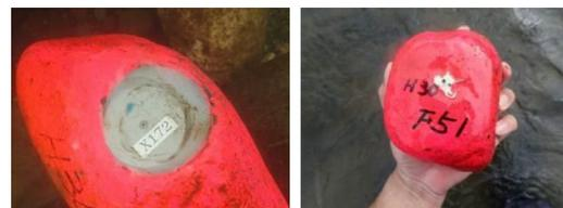
図1 [タスク a4]で用いたICタグを取り付けたマーカー
