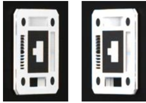
図 12：FDP による姿勢の不定性の除去 (下側の FDP の白黒の配置に着目)
