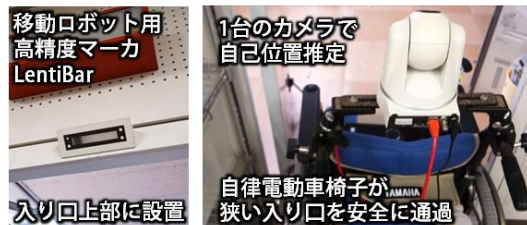
図 6：LentiBar とパンチルトカメラを用いた自律移動ロボットシステム
