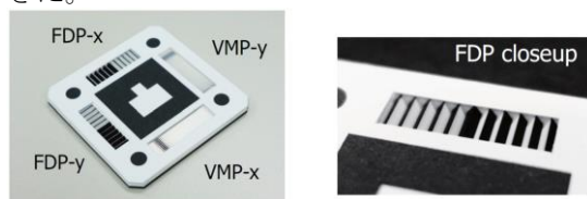
図 11：反転検知パターン（FDP）（右）と FDP を組み込んだ高精度マーク（左）
