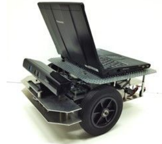
図1 軽量で、高速での人追従が可能であるが動作音が気になる従来型ロボット
