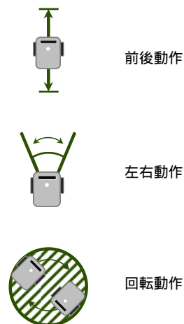
図4 ロボットの動作による意思疎通
