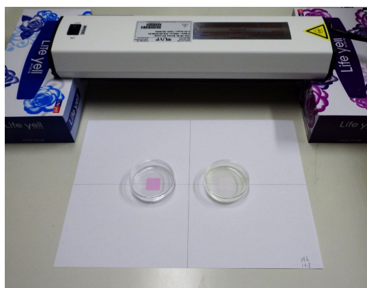
図4 ケルセチンの紫外線防御効果(左側のケルセチンなしのコントロールでは1分で紫外線感知を示すピンクの呈色が見られた)
