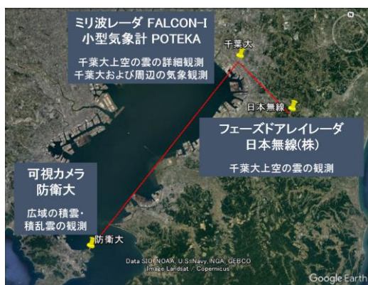
図 5. 千葉大サイトでの FALCON-I による観測とともに、横須賀市の防衛大および千葉市郊外からの X バンドレーダ観測を実施した。
