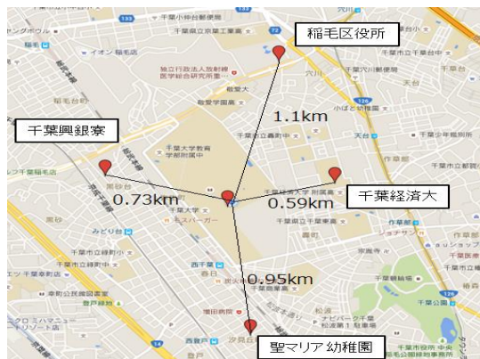
図 4. 積乱雲集中観測で、千葉大の周囲 1km 以内に、自動気象観測装置 POTEKA を配置し、雨量・風速風向などの局所的变化を観測した。
