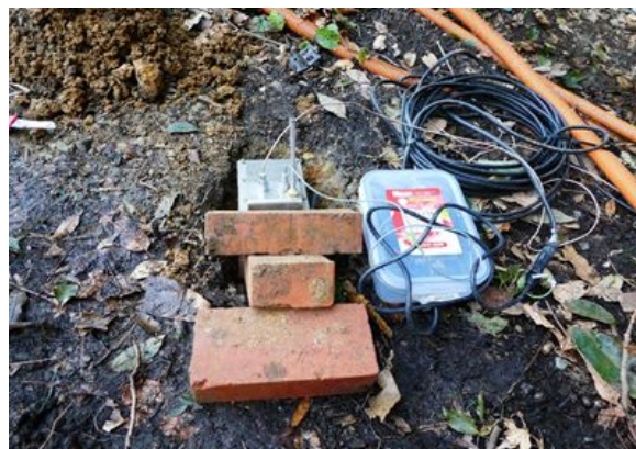
図 1 . 高出力加振器の設置状況。写真上が送信方向である。
