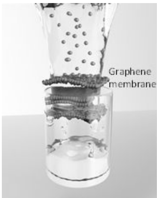
図 1 グラフェン/酸化グラフェン複合膜を使用した海水淡水化膜の概念図。グラフェンエッジ構造で構成された細孔の効果により、最高で 96%の塩分を除去できた。
