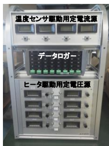
図 6 製作した多 ch 用センサシステムの外観と仕様
