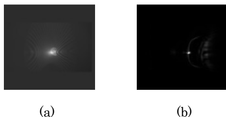
図 7 LED 光源を用いた蛍光 3 次元記録実験結果; (a) ホログラム, (b) 再生時の伝搬距離を変化させたときの再生像。
