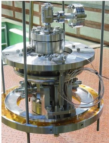
図8 空洞単体性能評価セットアップ
