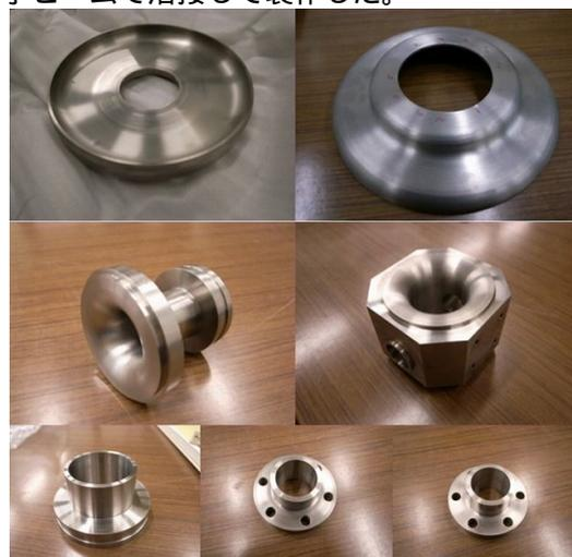
図7 ニオブ製空洞部品
