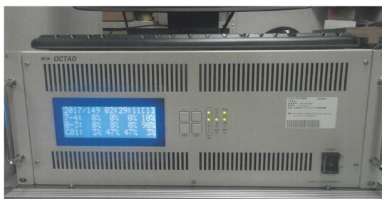
図 3(左) VERA 入来局に設置した、超高速 AD サンプラー (OCTAD)。
